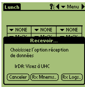
Figure 2 : Pour télécharger une configuration d'armoire, tenez le Palm parallèle au sol et à pas plus de 30 cm du port de réception, en haut à droite de l'armoire. Sélectionnez le bouton RX Mnems. Pour télécharger un journal de l'activité quotidienne, sélectionnez le bouton Rx Logs. Une boîte de dialogue s'affiche une fois le transfert terminé.
